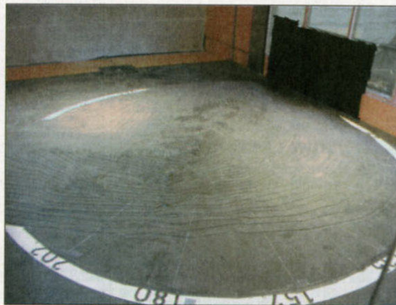
Suite aux 3.000 relevés de terrain réalisés l'an dernier en Antarctique, la maquette du site de la future base belge fait l'objet de tests en soufflerie à l'institut von Karman. Photos IPF/D. R.
