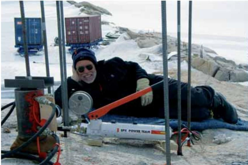
Figure 7 : Essai de traction sur barres scellées
