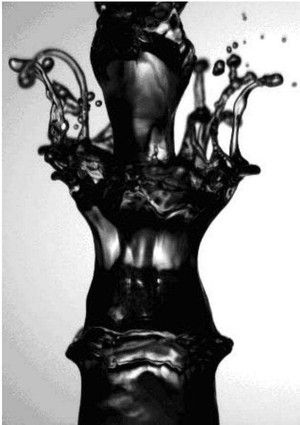
"Atomization of a Liquid Jet", picture from Prof. Villiermaux from IRPHE, Institut de Recherche sur les Phénomènes Hors Equilibres
