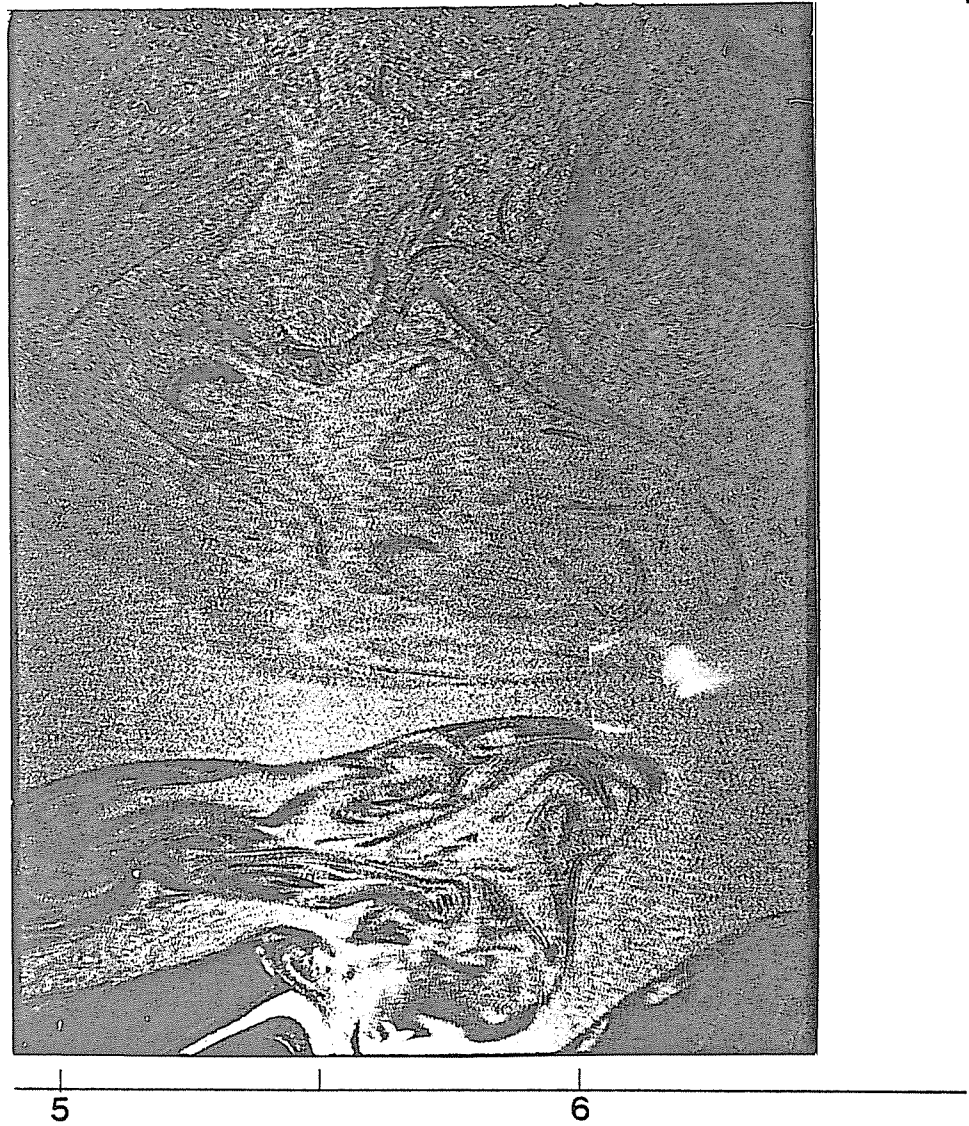
Fig.VI.61. Structure à grande échelle détectée à x/D = 6 .
