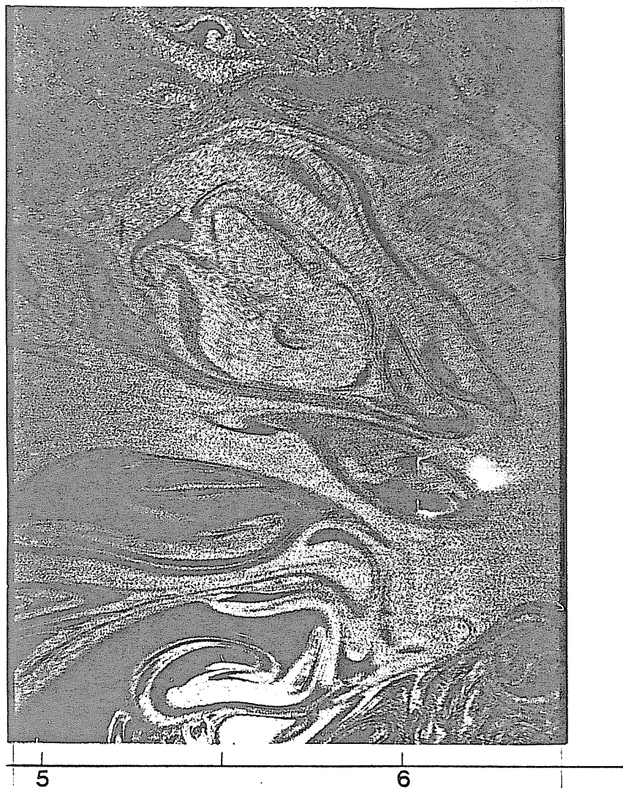
Fig.VI.55. Structure à grande échelle détectée à x/D=6 .
